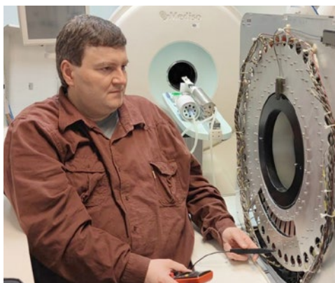
Pozitron Emissziós Tomográf (PET) berendezés javítása a SOTE kísérleti laborjában
